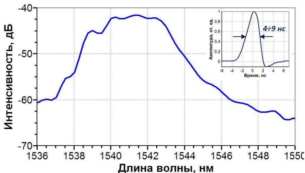
Рис. 4. Оптический спектр сверхдлинного лазера в режиме шумоподобной импульсной генерации.
